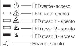
Fig. 4 - Stato di segnalazione bassissima concentrazione di gas
